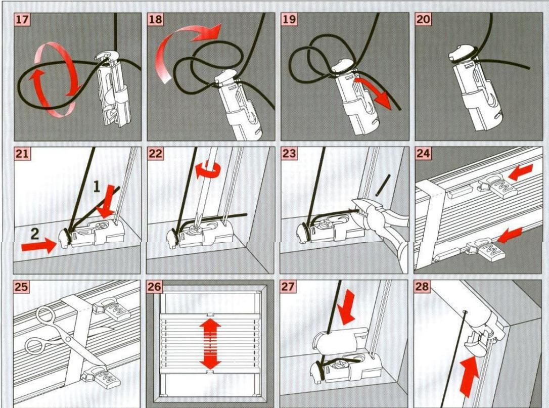
Demontage • Disassembly • Demontage • Démontage • Smontaggio • Демонтаж
